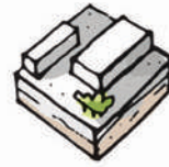
Piégeage du rayonnement solaire et écoulement de l'air perturbé par les obstacles construits qui empêche l'évacuation de chaleur la nuit, mais le jour l'ombrage améliore le confort.
