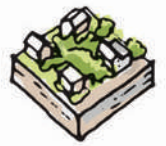
Piégeage du rayonnement solaire et écoulement de l'air perturbé par les obstacles construits qui empêche l'évacuation de chaleur la nuit, mais le jour l'ombrage améliore le confort.
