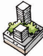
Piégeage du rayonnement solaire et écoulement de l'air perturbé par les obstacles construits qui empêche l'évacuation de chaleur la nuit, mais le jour l'ombrage améliore le confort.
